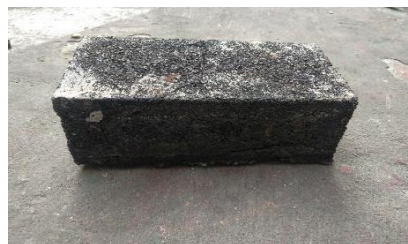
Gambar 2. Paving Blok Komposisi Sampah Plastik, Oli Bekas, dan Ampas Tebu
