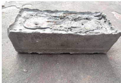
Gambar 1. Paving Blok Komposisi Sampah Plastik, Oli Bekas, dan Pasir
